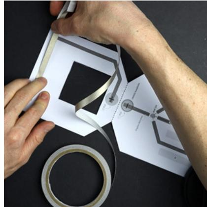
**Der Stromkreis:** Schneide die Vorlage aus. Beklebe die Leiterbahnen mit stromleitendem Klebeband.
