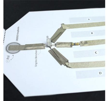
**Die Elektronik:** Befestige die LED und den Widerstand mit kurzen Streifen des stromleitenden Klebebands.
